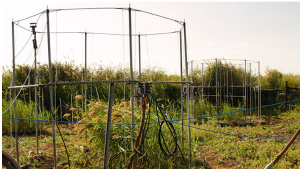
Planta de emisión abierta de CO2 en Las Tablas de Daimiel (Ciudad Real) parada / Foto: Salvador Sánchez
